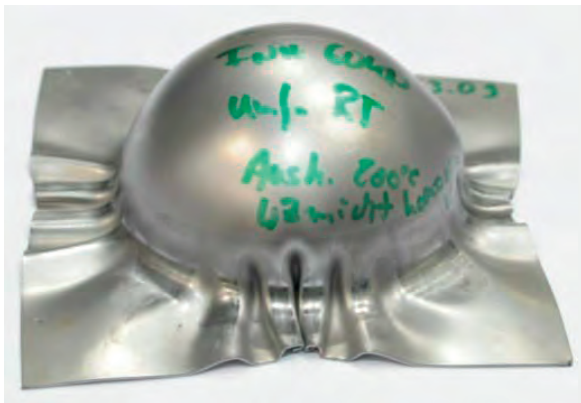
Abb: tiefgezogenes halbkugelförmiges Bauteil (links, Quelle: LUF, Universität Paderborn), Spannung während des Aushärteprozesses (rechts)
