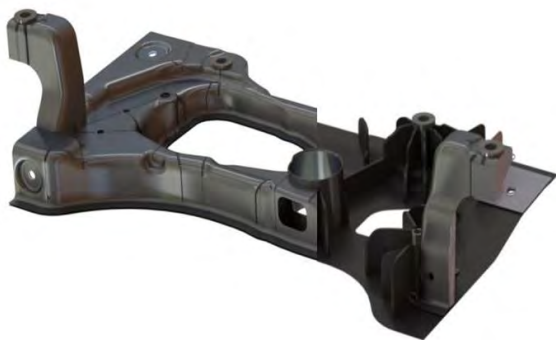
Abbildung 1: Prototyp hybrider Vorderachsträger
